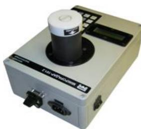
Микроволновой лабораторный влагомерМикрорадар 101 предназначен для экспрессного измерения влажности сухого молока, казеина, сахара, полимеров и других материалов с влажностью от 0 до 20 % в лабораторных и цеховых условиях. Сертифицирован в РФ. Госреестр средств измерений № 17787-98
