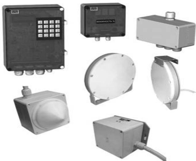
Микроволновой поточный влагомер МИКРОРАДАР 113К11К предназначен для бесконтактного измерения влажности торфа, гли
